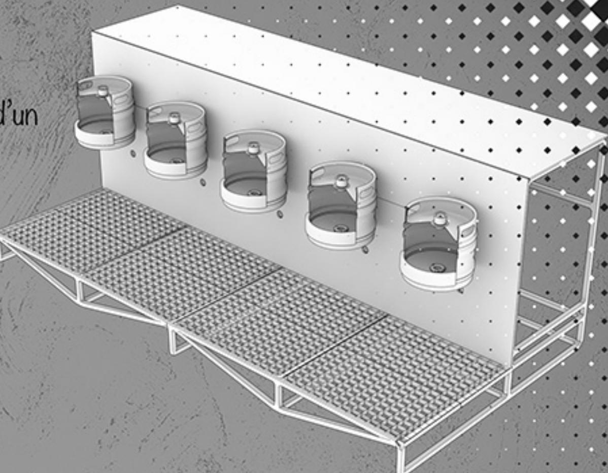
Le coffrage de la structure abrite la régie informatique ainsi qu'un dispositif de pompe automatique via trop plein. L'urine peut être évacuée vers le tout à l'égout, une cuve ou une citerne, jusqu'à une distance de cent mètres, en fonction de la pente rencontrée.
